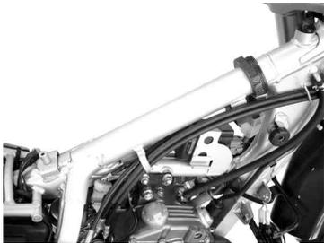
15. メーター電源用配線の茶コードと、パルス入力配線を接続し、イグニッションコイル付近まで取り回して下さい。余ったパルス入力配線は、ハンドルをきった時に余裕がある長さで切断して下さい。ハイテンションコードよりプラグキャップを取り外し、ハイテンションコードのイグニッションコイル付近でパルス入力配線を約3～5周巻き付け、ビニールテープ等で仮止めをし、熱収縮チューブを被せ、ドライヤー等でチューブを収縮させて下さい。
