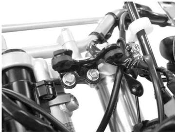
4. メーターステ-の固定ボルト2本を外し、トップブリッジより、メーターステ-を取り外して下さい。
