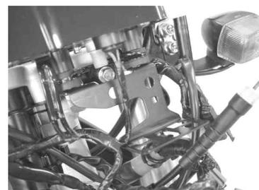
3. スピードメーターの固定ナット2個を外し、スピードメーター及びカブラ-ステ-を取り外して下さい。
