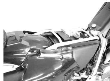
13. 左右シュラウドを固定してある各3本のボルトのうち、最下部のボルト左右各1本とフュ-エルタンクを固定してあるボルトを取り外して下さい。
