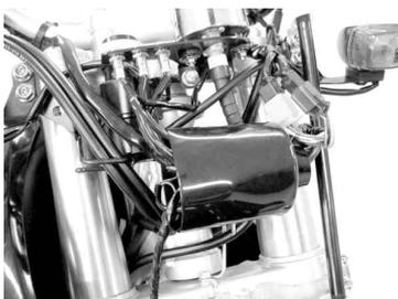
18. ヘッドライトの3Pコネクタを接続し、フロントバイザを取り付け、安全な場所で低速走行を行いスピードメーターの作動を確認して下さい。
