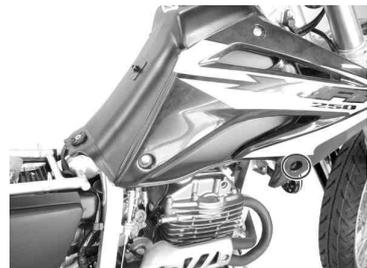
14. フュ-エルコックをOFFにし、フュ-エルコックよりフュ-エルチューブを外し、フュ-エルタンクを取り外して下さい。
