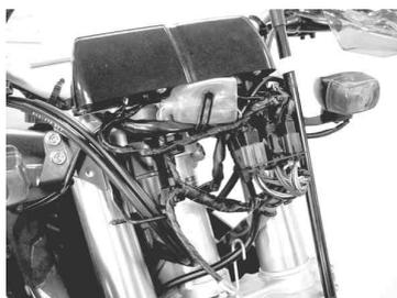
2. カブラ - ステ - のカブラ - 5個、左右ウインカーのカブラ - 、黄 / 赤コードのギボシを外し、スピードメーターケーブルをスピードメーターより取り外して下さい。
