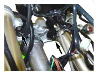
12. メーターステーにイグニッションスイッチをはめ込み、 イグニッションスイッチカバーにて固定して下さい。この時、メーターステーの凹部とイグニッションスイッチの凸部が合うようにはめ込んで下さい。
