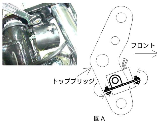
5. ヘッドライト後方の穴よりホーン配線を通し、端子を接続します。
