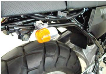
4. ウインカーの配線を接続し、メインスイッチをONにして左右ウインカーが正常に作動するかを確認して下さい。正常に作動しない場合は、バルブ切れやコードの接続不良等が考えられますので再度確認して下さい。
