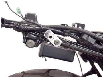
3. 別売りウインカーセット(09-03-091/092/093)を地面に対して水平になるように取り付け固定して下さい。
