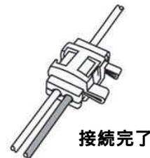
次に接続端子がついている方を折り返して下さい。プライヤーなどで完全にロックするまでしっかりと押さえて下さい。
