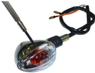
2. ウィンカーバルブを軽く押し込んだ状態で右に回し、ウィンカーバルブを取り外して下さい。
