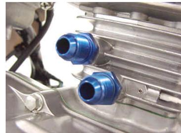
シリンダーに使用するアダプターは2種類有ります。先端の長いタイプの アダプターBを上側のオイルライン取だし穴に使用します。
