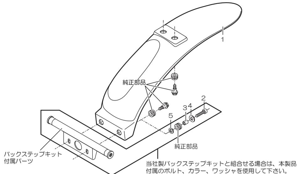
純正のクッションラバー、ボルトを使用し、ノーマルリアフェンダーと同様に取り付けして下さい。
