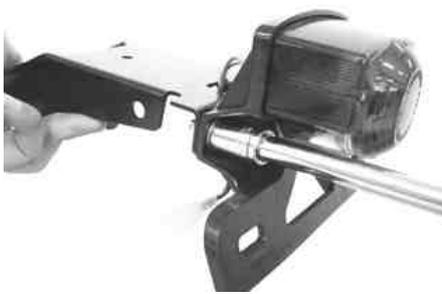
9. テールライトブラケットにウインカーステーをフランジボルト、6角ナットにて仮止めし、ウインカーをSTD ボルトでウインカーステーに取り付ける。
