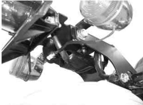
13. ウインカーが地面に対して水平になるように仮止めしたボルトを固定する。
