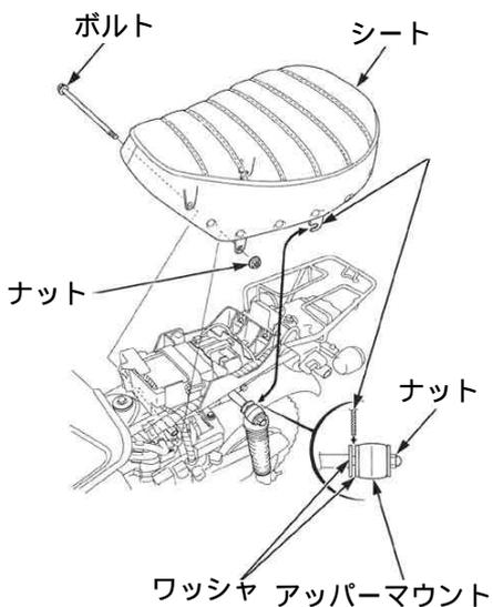
3. リアフェンダーを取り付けているキャリア下のボルト2本を取り外す。
