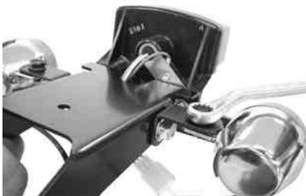
10. テールライトブラケットの裏側にワイヤークリップをフランジボルト、6角ナットにて取り付ける。
