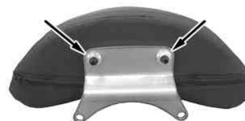
8. ボタンヘッドスクリーンを用いてバックレストASSY.を取り付け、規定トルクで締め付けます。
