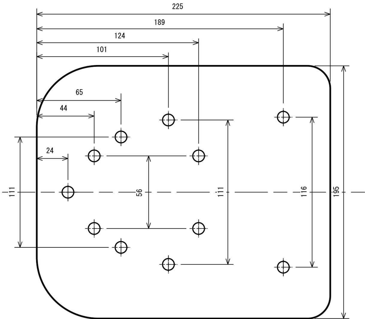
各部にあるネジ部と汎用性のある固定プレートにより、いろいろなレイアウトでシートとキャリアを固定出来ます。
