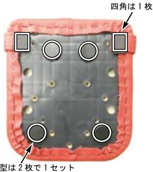
○写真に丸印してある取り付け穴を使用し、ボルト、ステー、スチールスペーサーの順番で、純正リアキャリアにピリオンシートを取り付けます。
