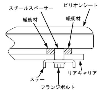
○ボルトを締める際、順番に均等に締め付け、座当たりがしたら、規定トルクで締め付けて下さい。
