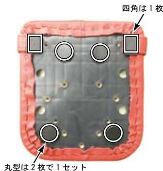
○写真に丸印してある取り付け穴にスタッドボルトを立てて下さい。その際にネジロックを必ず塗布して下さい。
