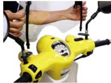
○左右のブラケット ASSY. のネジ部に⑬ワッシャ 10mm と⑮袋ナット M10 を各 1 個ずつ仮取り付けします。
