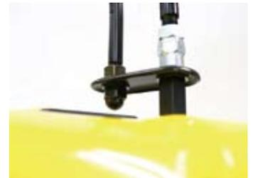
○カウルとの隙間を確認しながらスクリーンの位置を定め、各仮取り付け部を締め付けます。
