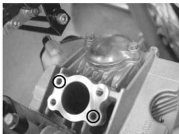
シリンダーヘッドとインレットパイプの間にガスケットを挟み、ソケットキャップスクリューM6×20で取り付けます。
