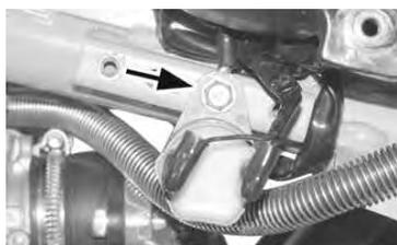
シリンダーヘッドの丸印のボルト穴にインレットパイプを組み付けます。
