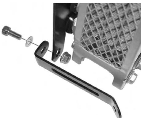
3. L シュラウドの、燃料タンク側のスクリーを仮止めしてから、先程仮止めしたオイルクーラステー 2 の位置を調整し、L シュラウドに純正スクリーを通して、オイルクーラステー 2 の裏から、M6 フランジナットで固定します。
