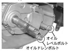
2. リダクションギヤカバーボルトを対角線上 に緩め、リダクションギヤカバー、ドライブ シャフト、リヤアクスルシャフトをセット で取り外します。
