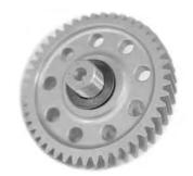
3.ドリブンギアを組み替えたアクスルシャフト を組み付け、各ギアとシャフトにエンジンオ イルを塗布します。
