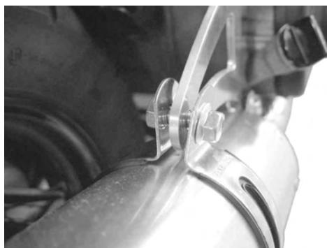
5. ステーに取り付けたカラーにフランジボルト6×25を通し、フランジナットM6を用いてマフラーCOMPのエキゾーストパイプ部を取り付け、仮締めします。
