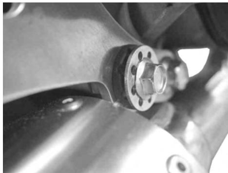
6. エキゾーストパイプナットを規定トルクで締め付けます。
