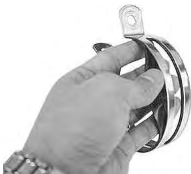
4. ステーとサイレンサーバンドをフランジボルト8×20及びフランジナットM8を用いてステーを挟む様にして取り付け、仮締めします。
