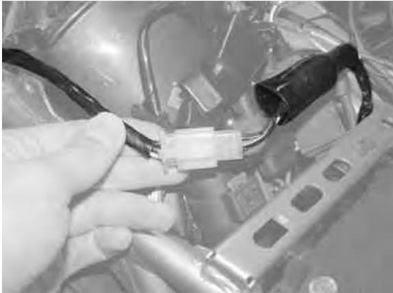
2. サブハーネスのギボシ端子側を、テールカウルの純正ハーネスが通っていた部分に通します。
