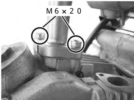
キット内のインレットパイプとキャブレターの間にキャブレターガasketを挟み、ソケットキャップスクリューで締め付ける。
