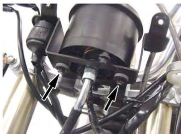
5. メーターサブコードをSTDメーターコードと同じ取りまわしてフレームに沿わせ、左タンク下車体側面のスピードメーター用6極カブラ(黒)と接続して下さい。
