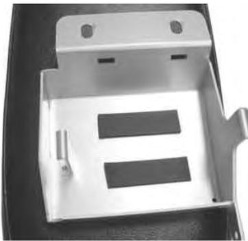
フレーム、バッテリーケース、フェンダーレスプレートの順になるようにフェンダーレスキットに付属のボルト、ナットを使用し仮締めしておきます。
