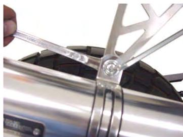
クランプバンド部のボタンヘッドスクリューを規定トルクまで締め付けます。
