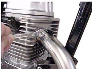
シリンダーヘッドEXポート部のフランジナットを均等に規定トルクまで締め付けます。
