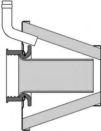
2. エアフィルターComp.のラバーにクランプバンドを通してから、純正スロットルボディに取り付けます。
