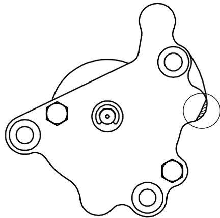
2. R .クラックケースカバーCOMP .内側のクラッチレリーズラックが入っていることを確認し、クラッチケーブルレシーバーを取り付けるフランジボルト以外のボルト6本にアルミワッシャを取り付け、クラックケースに仮締めし、ケース中央から外側へと対角に指定トルクで締め付けます。
