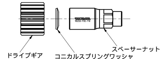
2. クラックシャフトの回り止めをした状態でロックナットを指定トルクで締め付けます。
