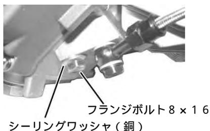
12. オイルホースがシリンダーやマフラーに干渉しない位置になる様バンジョーボルトの締め付け角度を調整し、バンジョーボルト、オイルホースフィッティングを取り付けします。
