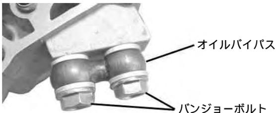
11. キット付属のフランジボルト8 X 16、シーリングワッシャ(銅)を下側のラインに、図を参考に、シーリングワッシャ、ユニオン、バンジョーボルトを上側のラインに借り締めします。
