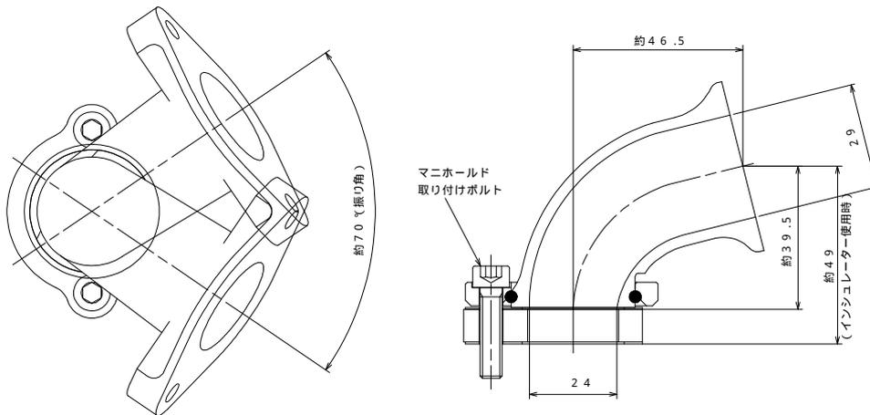
1. シリンダーヘッドにインレットパイプガスケット、マニホールドの順で取り付け6×1.6のソケットキャップスクリューで仮締めする。
