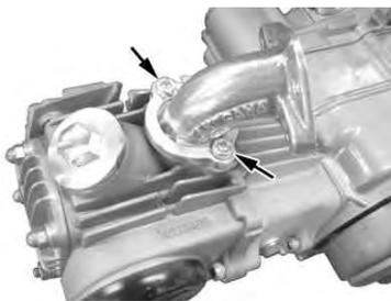
キャブレターがクランクケースに干渉する場合等は、シリンダーヘッドにインレットパイプガスケット、インシュレーター、インレットパイプガスケット、マニホールドの順で取り付け6×2.5のソケットキャップスクリューで仮締めする。
