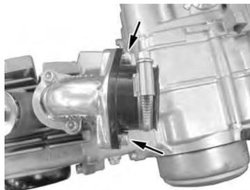
3. キャブレターをインシュレーターに差し込み、クランプバンドで締め付ける。
