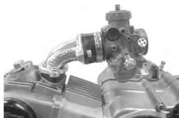
4. マニホールドを回転させキャブレター等が他部品と干渉しないように調整しマニホールドの取り付けボルトを締め付ける。
