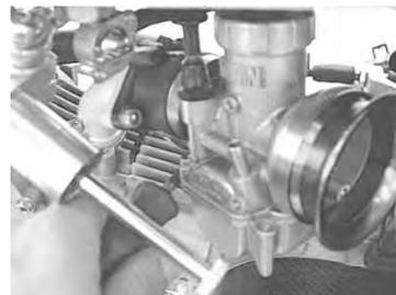
スロットルグリップで5mm程度の遊びを確保し、ステアリングを左右にきった時でも遊びがある事を確認し、スロットルを数回スナップさせ、引っ掛かりやスロットルバルブの全開状態を確認します。
