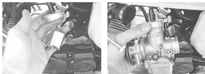
キャブレターをインシュレーターに差し込み、インシュレーターバンドを締め付け、キャブレターを取り付けます。
