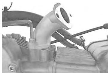
インシュレーターをインレットパイプにキャップスクリューM6×15 2本を用いて取り付け締め付けます。
