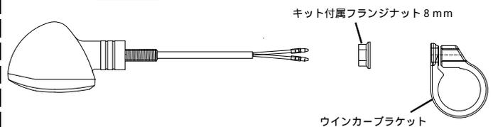
キット付属のナットを取り付け、ウィンカーブラケットに取り付けた後ナットで固定して下さい。
