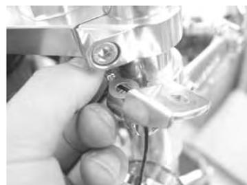
6. Gorillaは、ソケットキャップスクリュー6×20、Monkey (FI)は、ソケットキャップスクリュー6×15を通し、アース線、ワッシャ(純正) ウィンカー(純正) キット付属のラバー8.4×18×1.5を通し、ウィンカーステーBへ取り付けます。
