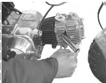
プラグキャップをプラグから引っ張って取り外す。必ずキャップ部分をつかんで引っ張って外して下さい。
