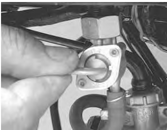
ガソリンタンク左下部にあるガソリンコックをOFFにする。
