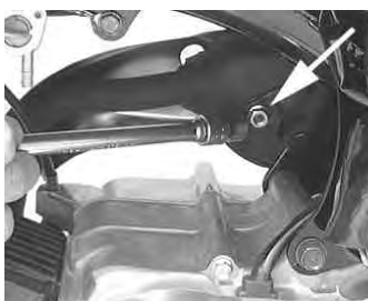
マフラー本体裏側に止まっているナットを反時計方向に回し取り外す。
