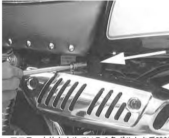
マフラー本体を止めている 6 角ボルトを反時計方向に回し取り外す。
