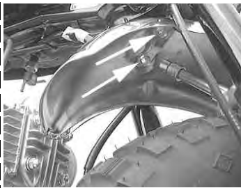
フロントフェンダー裏側の 6 角ボルト 2 本を反時計方向に回し取り外す。
