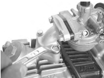
シリンダーヘッドとインレットパイプを止めているボルト 2 本を取り外す。
