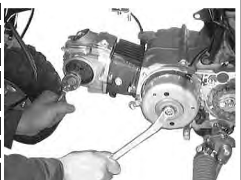
フライホイールを固定しカムスプロケット 6 角ボルト 2 個を反時計方向に回し取り外す。
