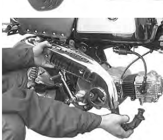
シリンダーヘッドとインレットパイプを止めているボルト 2 本を取り外す。
